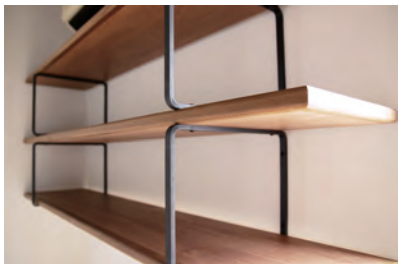
リングの棚受け ■大サイズ／小サイズ／雑誌サイズ 大／雑誌サイズ 小 size ：大サイズW15×D320×H260×T8mm 小サイズW15×D220×H260×T8mm 雑誌サイズ 大W15×D320×H350×T8mm 雑誌サイズ 小W15×D220×H350×T8mm material ：鉄 finish ：黒皮ウレタンつや消し塗装 accessory ：取付用ビス7本
