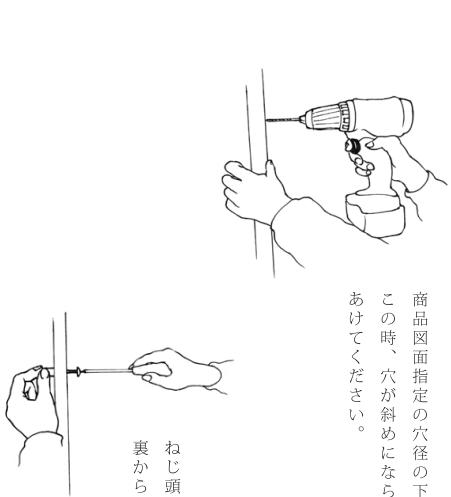
ねじ頭の十字をなめないように気をつけながら、裏からプラスドライバーで手締めをします。
