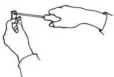
かならず壁または扉におしあて、プラスドライバーで手締めをします。ねじ頭のプラスに合ったドライバーをご使用ください。
