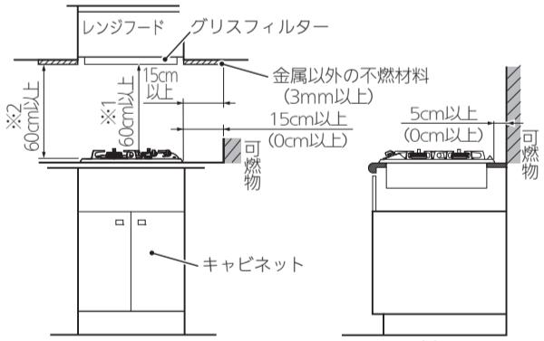
※( )内は、周囲の壁を不燃材料で有効に仕上げた部分もしくは、防熱板を取り付けたときの寸法です。
