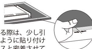
貼り付ける際は、少し引き伸ばすように貼り付けて、ガラスと密着させて下さい。
