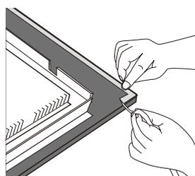
本体のクックトップの裏側（カウンター側）にクッションテープを取り付けます。この際にクックトップの表側に傷をつけないように気をつけて下さい。テープは外周部に貼り付けて下さい。
