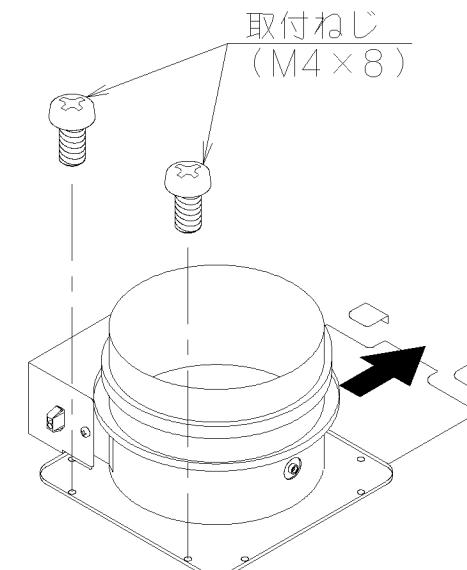
(4) 電動シャッター信号線と排気口を接続します。
