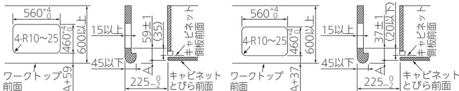
穴あけ寸法はA+59が標準です。ただし、設置フリータイプですのでワークトップ穴あけ寸法はA+59、(A+45)、A+37のどちらでも設置できます。
