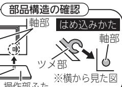
③ 操作部のふたを押し込み、操作部に取り付けてください。
