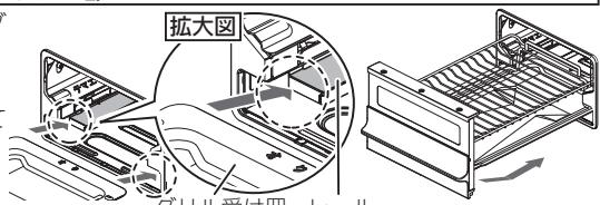
グリルとびらが閉まりにくい場合やこすれる音がした場合は、サイドカバー、グリルとびら、グリル受け皿、グリル焼網支持台、グリル焼網が正しく取り付けされていません。そのまま押し込むと、変形や損傷の原因になりますので、再度正しく取り付け直してください。
