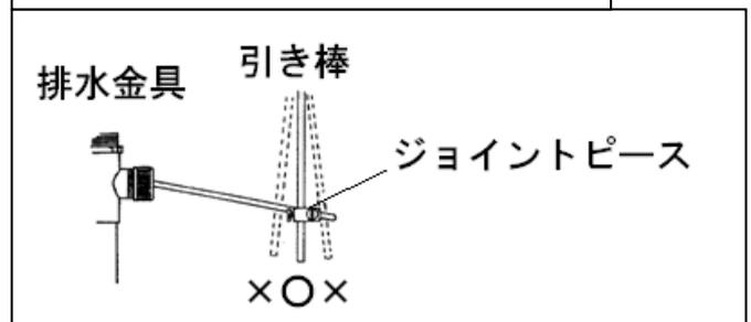
引き棒に仮固定されているジョイントピースを外し、排水キック棒に差し込みます。
