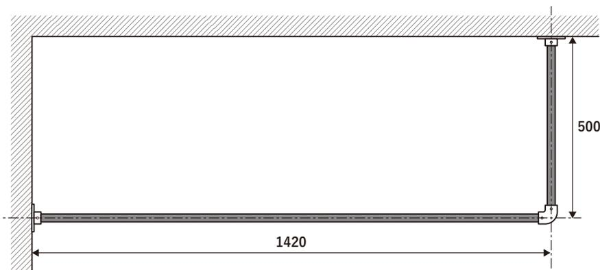
※ 幅 (W) : 吊りパイプの中心 ~ 壁までの寸法です。
