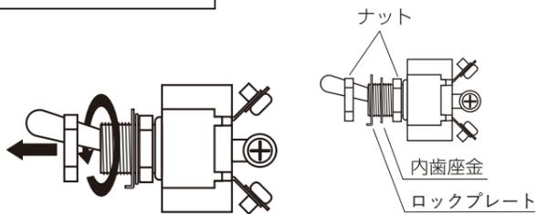
ナット2枚、取付リング、内歯座金を全て外します。
