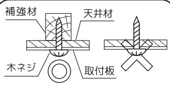
⚠ 注意 建物の構造によっては、付属の木ネジでは取り付けられないことがあります。そのような場合には器具取り付け場所の構造を確認の上、適切な長さの木ネジにて取り付けてください。
