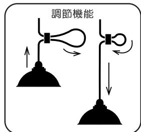
⚠ 注意 その際セード止めネジを強く締め込みすぎてセードが破損しないよう注意してください。
