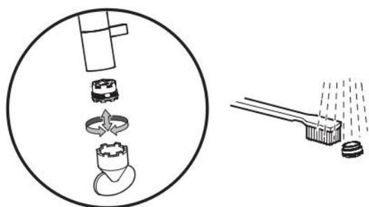
エアレーターは吐水口にねじ込まれています。付属専用工具にてエアレーターを外し、ブラシなどで汚れを落としてください。
