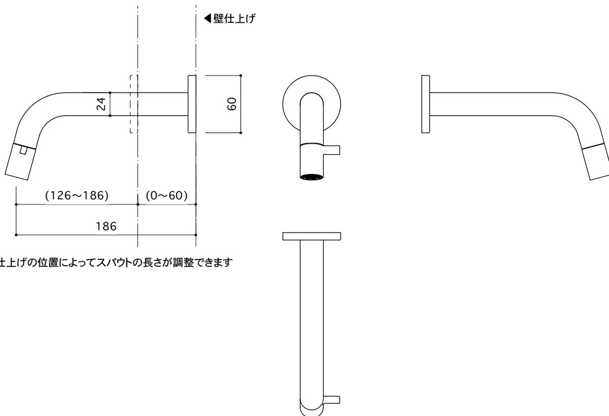
壁仕上げの位置によってスパウトの長さが調整できます
