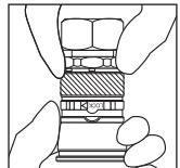
②ロックリングを矢印の方向にカチッと音がするまで(約90°)回すと[ロック状態]になります。
