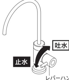
【注意】レバーハンドルは無理な力を加えずゆっくり操作してください。急な操作や無理な力での操作はウォーターハンマー（水撃）音が発生し、配管からの漏水により家財などを濡らす財産損害発生のおそれがあります。
