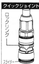
●クイックジョイント(入口)のロックを押し下げながら90度回し、アンロック位置にしてからスライダーを引き上げてカートリッジより取外します。同様に出口側も取外します。
