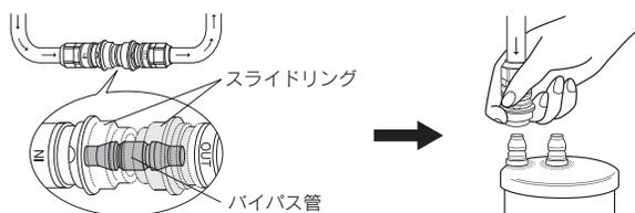
シンク下で浄水カートリッジにIN側・OUT側ホースが接続されているか確認してください。
