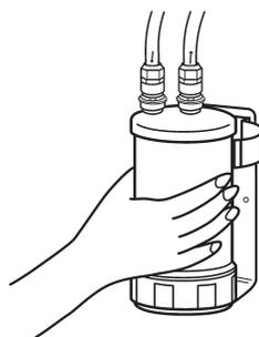
浄水の水切れを良くするため、浄水を流しながら浄水カートリッジを逆さにして数分間振って空気を抜いてください。浄水カートリッジ取付直後は、浄水カートリッジ内に空気が残っているため、浄水器用レバーを閉めてから完全に水が止まるまで時間がかかる場合があります。
