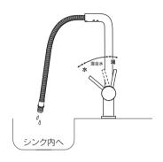
④シャワーヘッドを取り付けた後、レバーハンドルを湯・水の各位置で吐水・止水しながら繰り返し操作して配管接続部の水漏れがないことを確認する。また、浄水用レバーにおいても同様に確認する。 さらに、シャワーへの切替もスムーズに行えることを確認する。
