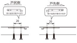
④穴の位置に合わせて図のようにレールの下から 受け金具を取り付けてください。 取付けには付属のビスを使用してください。
