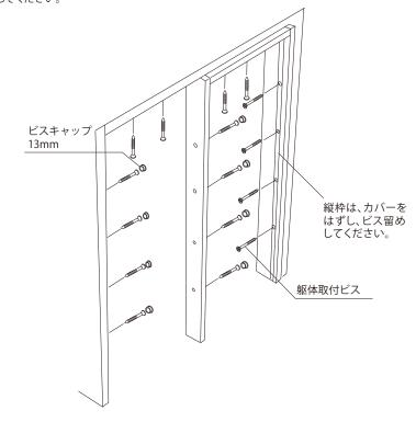
※施工後の枠が下図にならないように水平・垂直 および開口寸法の確認をしてください。
