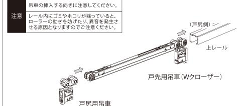
②上レールをレール取付ビスで上枠に取り付けてくだ さい。
