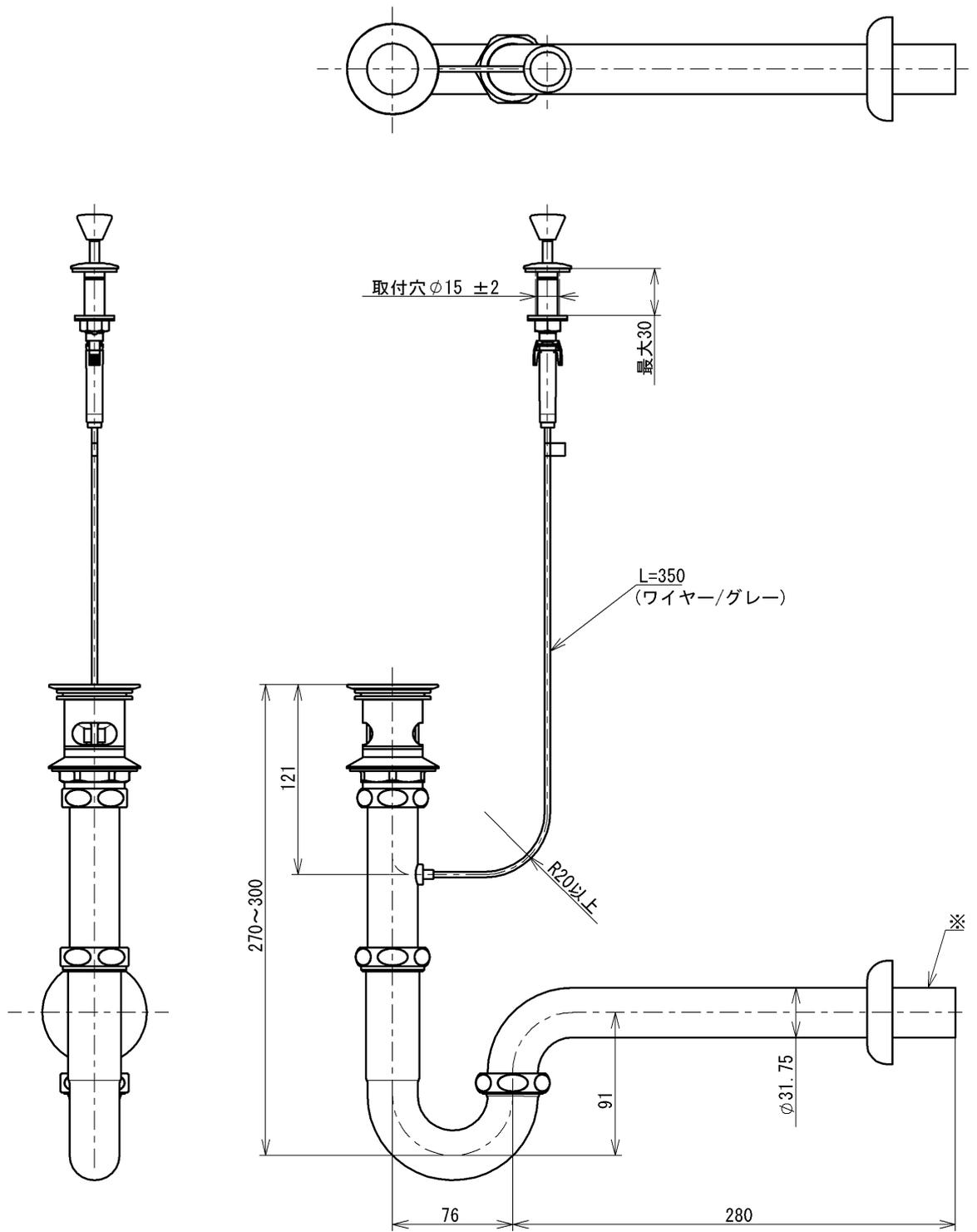
※現場で排水パイプを必要長さにカットして使用する場合は壁差し込み代
