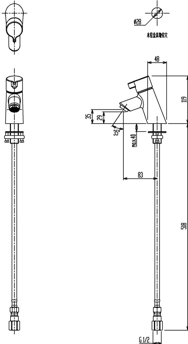
※必ず水栓本体からフレキホースを外した後、水栓本体を洗面器やカウンスターに水栓締付ナットを用いて固定ください。
