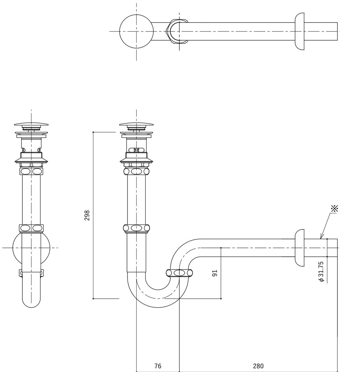
※現場で排水パイプを必要長さにカットして使用する場合の床差し込み代
