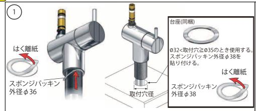
同梱のスポンジパッキン(外径 $\phi$ 36)のはく離紙をはがして、水栓下部へ貼り付けてください。
