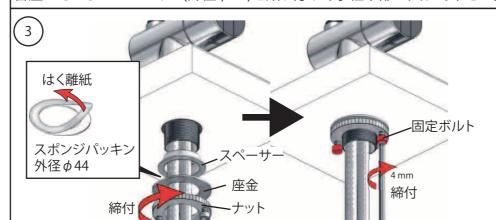
同梱のスポンジパッキン(外径 φ 44)のはく離紙をはがして、座金に貼り付けカウンター側に向くようにスペーサー、座金、ナットの順に水栓に取付けてください。
