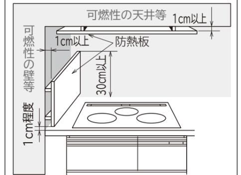
防熱板はこれを設けたとき、機器周囲の可燃物の温度が室温35℃の時100℃を越えない断熱性を有すること。
