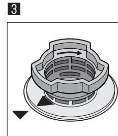
フィルターを組み立て、サンプに戻した後に矢印が向き合うまで回す
