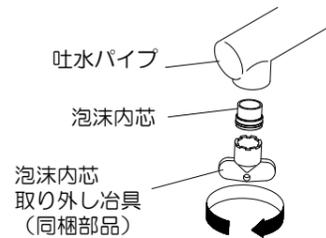
同梱されている取り外し治具を使用し泡沫内芯を外して、網目や穴に詰まったゴミをブラシなどで取り除いて下さい。
