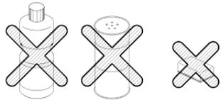
クレンザー、みがき粉、粗い粒子を含む洗剤およびナイロンたわしなどはメッキ面を傷つけますので使用しないで下さい。また、酸性洗剤、塩素系漂白剤、銲物性潤滑剤、シンナー、ベンジンなどは樹脂部分を傷めますので使用しないで下さい。間違っても使用したときはすぐに水洗いして下さい。
