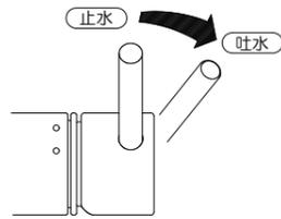
湯水の量はレバーハンドルの左右操作で調整します。
