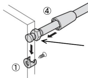
①のフロントクリップと④のサイドレールを外すとサイドレール側のフックが回転できます。これにより前板の出入りを調整できます
