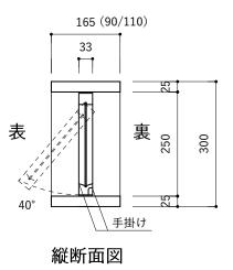
※ ( / ) 内寸法は枠の奥行がD90mmタイプ あるいはD110mmタイプの場合
